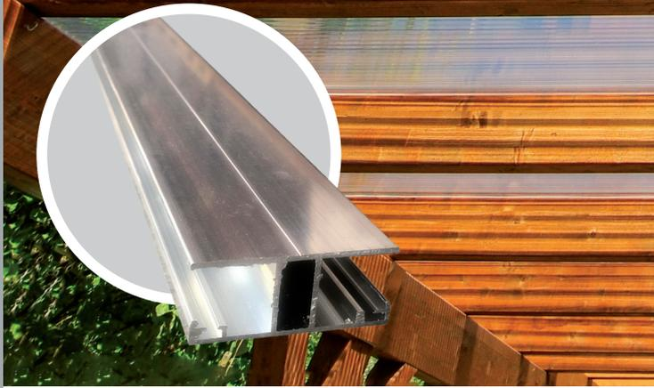
Les profils H monobloc sont des profils économiques permettant la réalisation de toiture ou bardage en polycarbonate alvéolaire 16 mm. Les profils se posent sur une ossature existante. Ils ont également une portée entre appuis de 1,60 m.
