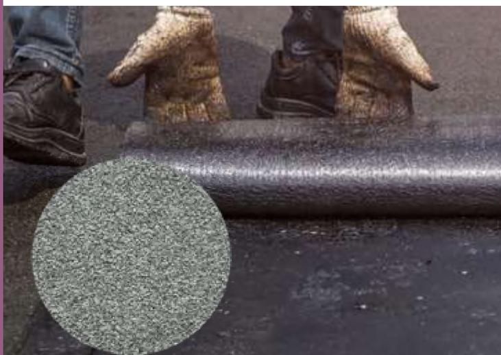
**Dhaze PE4M** est une membrane bitume élastomère SBS (styrène-butadiène-styrène), armée d'un feutre en polyester. Recouverte en surface supérieure de paillettes ardoisées et en surface inférieure d'un film thermofusible.
